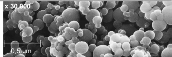
Ein trockener Feinstaub (amorphe Kieselsäure), der bei der metallurgischen Erzeugung von Silicium im Lichtbogenofen entsteht.
